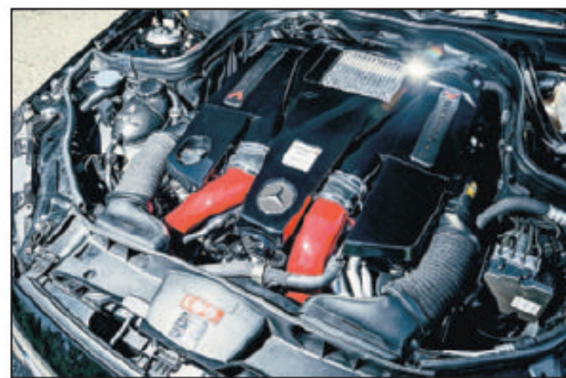
Ændringerne på turboladerne stiller større krav til kølesystemet, som derfor også er opgraderet – i alt yder motoren ca. 820 hk.
